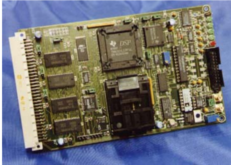
Moduł DSP systemu skanowania kanałów
